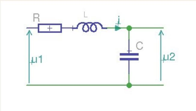
C'est la réponse à une impulsion de Dirac. Dans le cas présent nous appliquerons une impulsion de tension à l'entrée et étudions la tension en sortie, dans le cas où les conditions initiales sont nulles.
