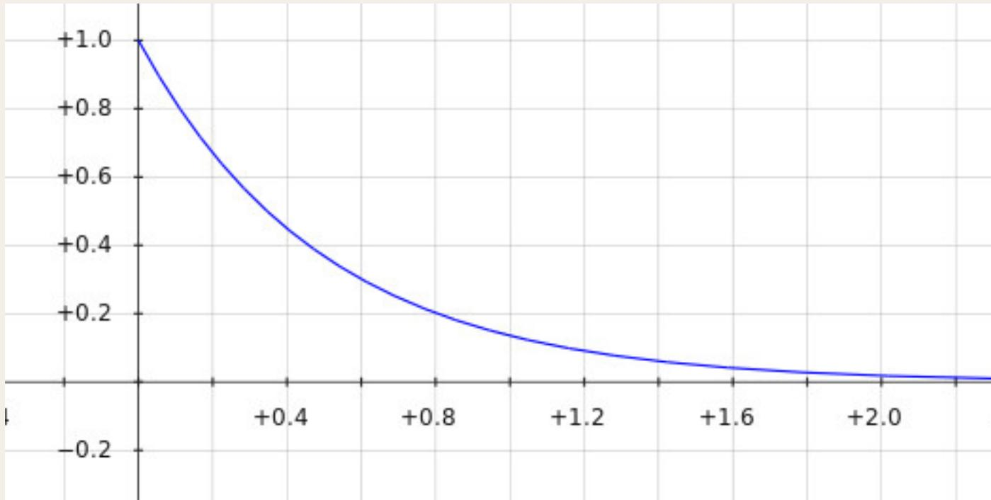
Ce circuit est aussi appelé différenciateur : il permet comme on le voit, dans le domaine impulsionnel d'obtenir facilement... des impulsions (qu'on peut facilement mettre en forme avec un circuit logique pourvu d'un hystérésis en entrée, CD40106 ou 74F14 ou bascule à deux transistors par exemple...) à partir d'un signal carré.
