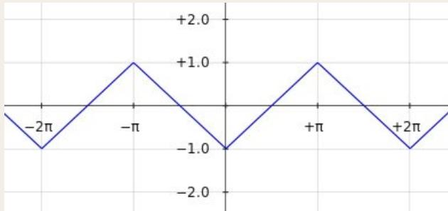
Le signal triangulaire en question est symétrique et ne comporte pas de fronts raides au contraire du « signal en dent de scie »
