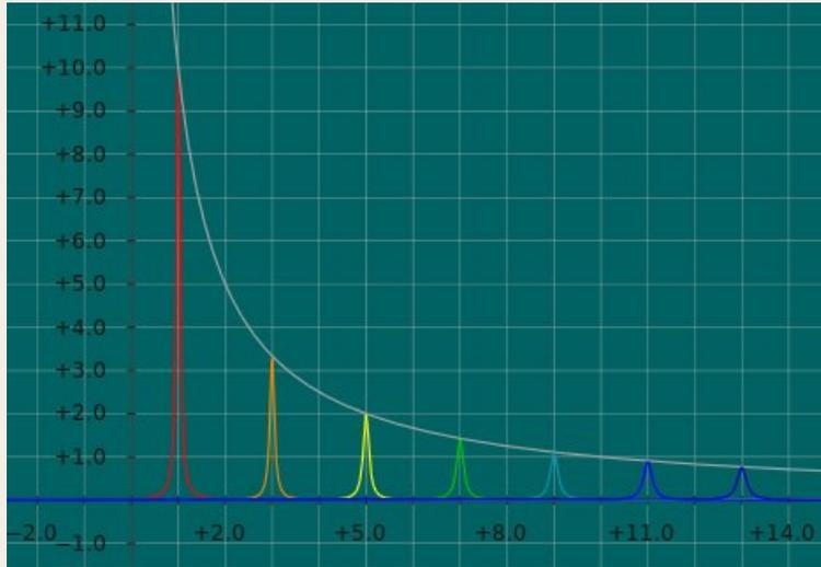
Voici ce spectre (dessiné) pour notre signal carré. Les amplitudes décroissent suivant une courbe en  $1/f$ .
