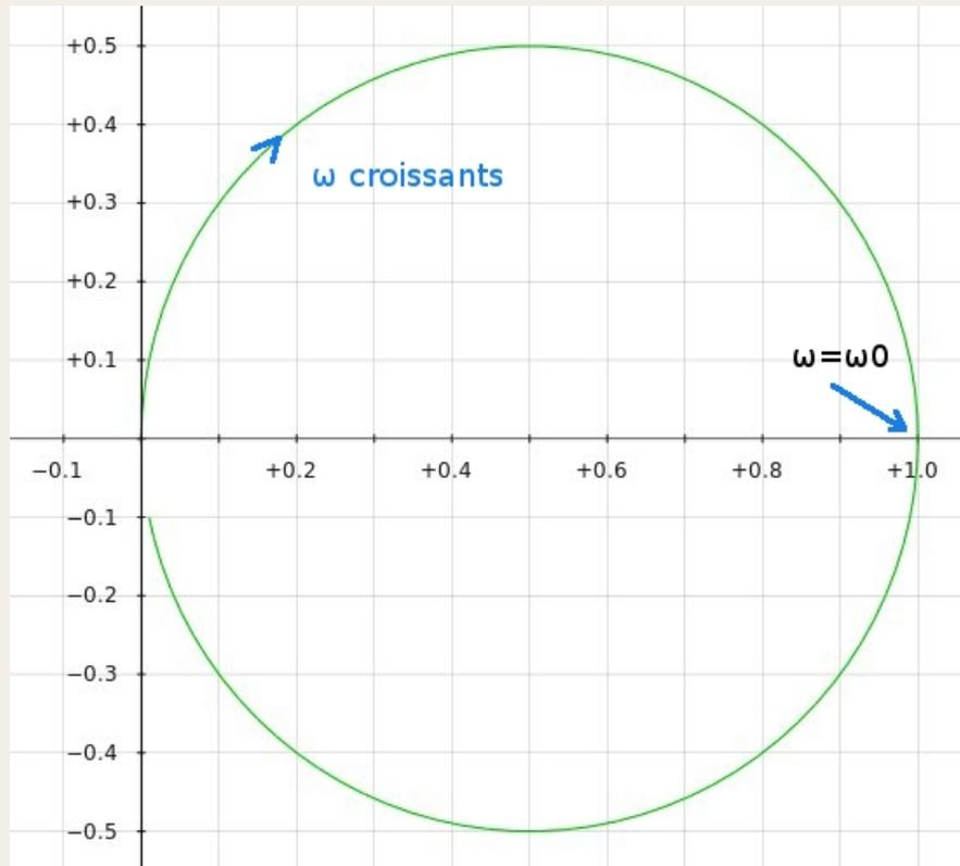
Courbe paramétrique de la fonction de transfert dans le plan complexe, avec en abscisses, la partie réelle et en ordonnées sa partie imaginaire, en fonction du paramètre  $x = \omega / \omega_0$
