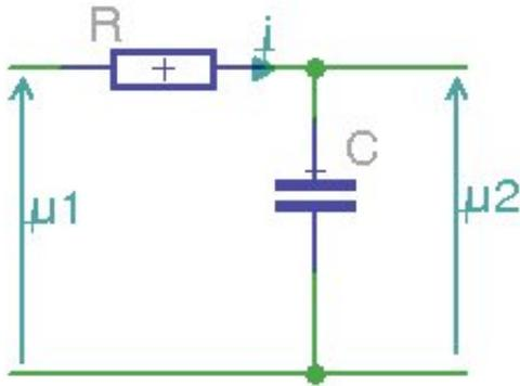
Soit le quadripole ci-contre constitué d'une résistance en série et d'un condensateur en parallèle. C'est un filtre passe bas du premier ordre, comme nous allons le voir.
