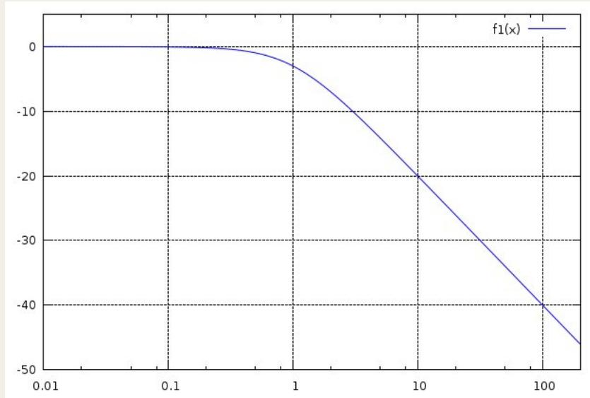
La pente de la courbe au delà de la fréquence de coupure  $\omega = \omega_0$  est égale à  $-20\text{dB}$  par décade.
