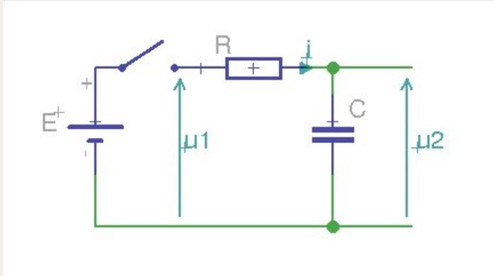
Soit le circuit ci-contre constitué d'une source de tension continue de valeur  $E$  d'une résistance  $R$ , d'un condensateur  $C$  et d'un interrupteur.
